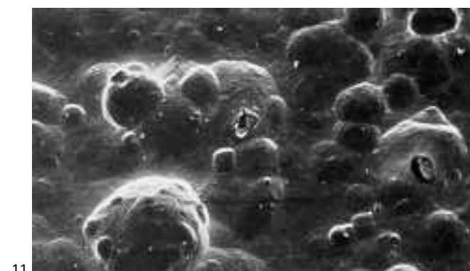
Bilder 10a und b und 11: REM-Aufnahmen von anodisch oxidierten, künstlich durch verschärften Salzsprühstest nach DIN 50021 korrodierten Proben; Bild 10a ungereinigt, V = 860:1; Bild 10b wie a, V = 4300:1; Bild 11: mit dem sauren Reiniger behandelt; V = 860: 1
