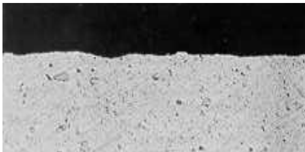
Bild 2: Oberfläche analog Bild 1, mit einem neuen sauren Reinigungsmittel *) durch Tauchen behandelt; Oxidschicht ist unverändert
